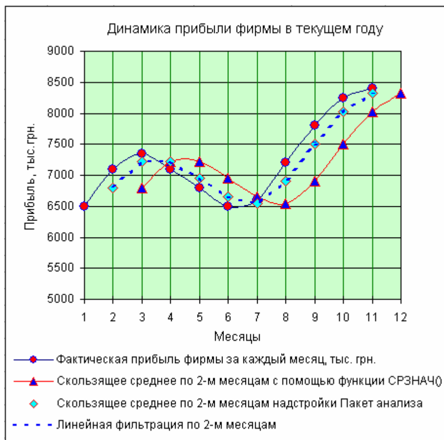
Рис.20. Графики исходного временного ряда, 2-го месячного скользящего среднего, полученного с помощью функции СРЗНАЧ, инструмента Скользящее среднее надстройки " Пакет анализа " с добавлением линии тренда типа Линейная фильтрация
